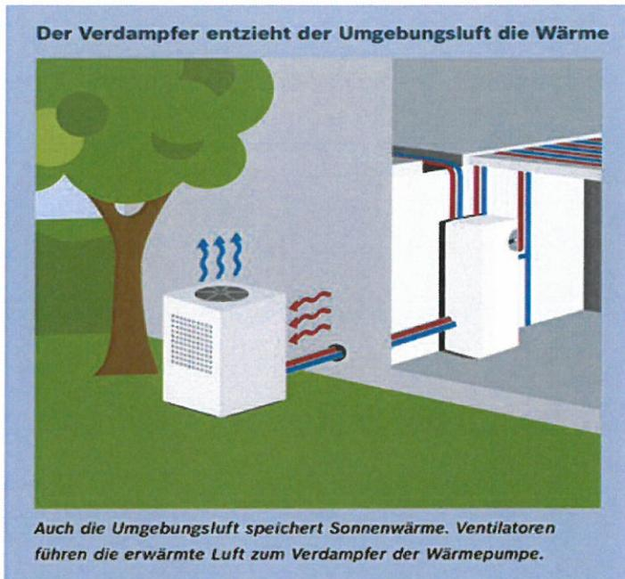
*Eine Luft-Wasser-Wärmepumpe ist in der Lage, der Umgebungsluft auch bei niedrigen Temperaturen von bis zu minus 20 Grad Celsius Wärme zu entziehen. Das liegt daran, dass selbst bei dieser Temperatur das eingesetzte Kältemittel verdampft.*
